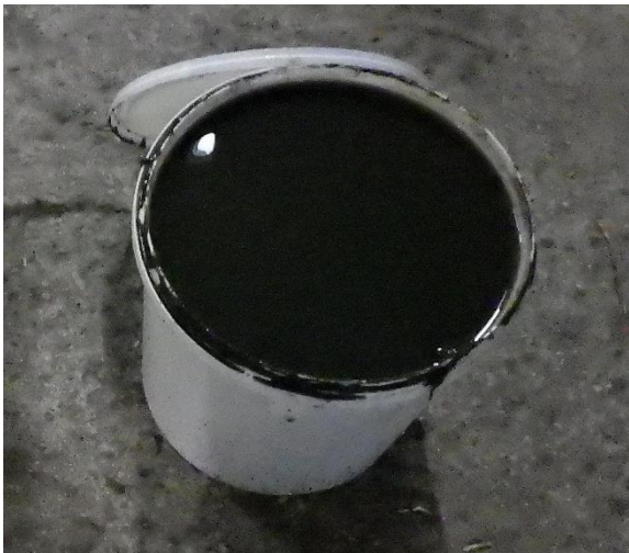
Foto 2.1.1. Sediment van het Twentekanaal, dat nog zeer nat was, bij aanlevering aan Soil Best in mei 2020.
